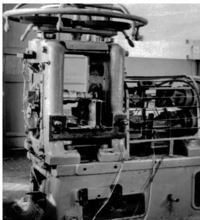
Рис. 1. Рабочая клетка лабораторного стана 200/250 ДГМА, используемый при физическом моделировании процесса прокатки листов и полос в вертикальных рабочих валках: а – общий вид; б – узел валков
