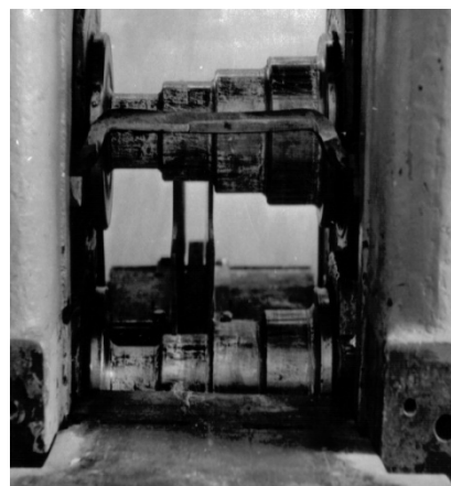
Рис. 1. Рабочая клетка лабораторного стана 200/250 ДГМА, используемый при физическом моделировании процесса прокатки листов и полос в вертикальных рабочих валках: а – общий вид; б – узел валков
